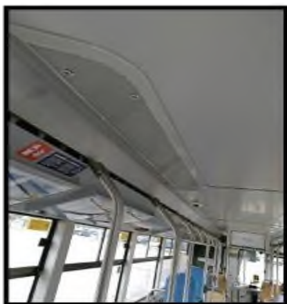
Obrázek č. 13 Umytí stropních krytů klimatizace
