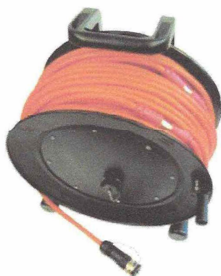
SEKCE MULTIELEKTRODOVÉHO KABELU II
