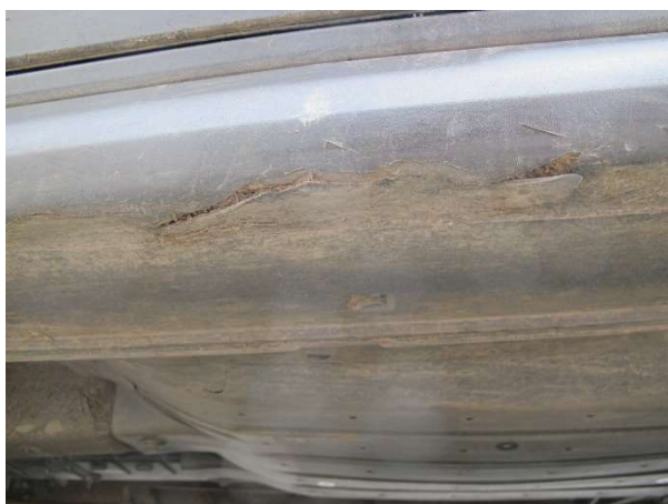
Poškození spodního plastu vnějšího prahu
