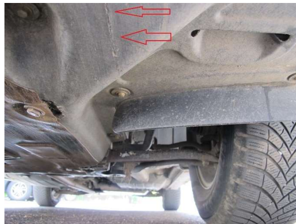
Pravé zadní kolo zdola a poškození krytu
