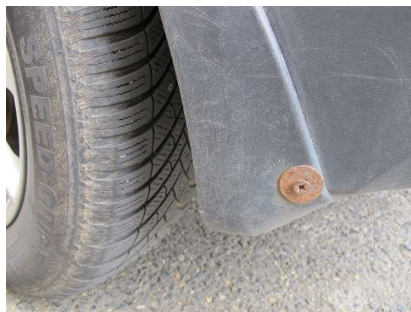
Oprava utřeného plastu u LZ kola
