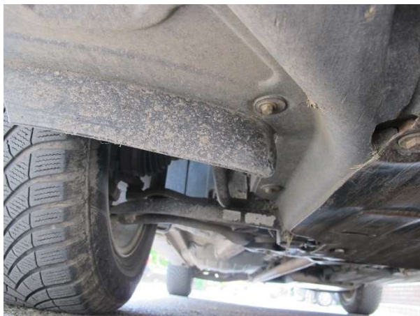
Levé zadní kolo zdola a poškození krytu
