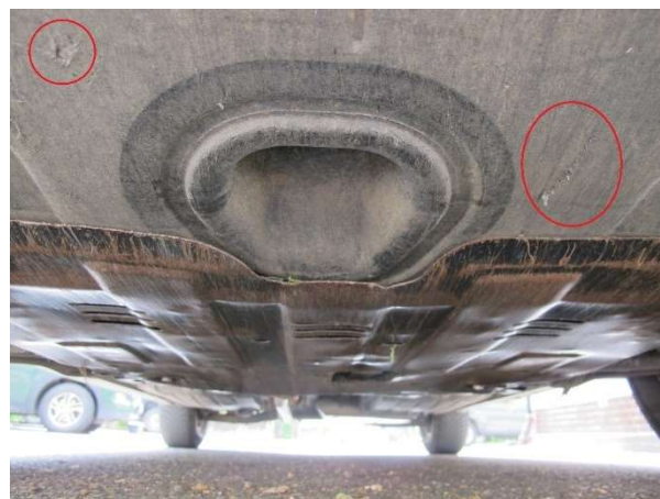
Spodek vozidla zepředu a poškození krytu
