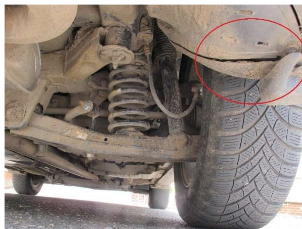
Spodek vozidla zepředu a poškození krytu
