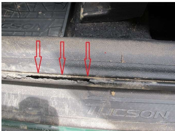
Koroze vika zavazadlového prostoru
