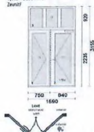
Průtlač 13 Kování křídla křídla, sámek jednobodový, RAL 9016-matná, 93 kg, hrubé rozměry: křídla = 754 mm, výška = 2235 mm. Záruka 5 let
