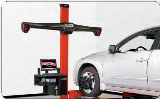
Kamery umístěné na pevném sloupu vyhovují většině dílen.
