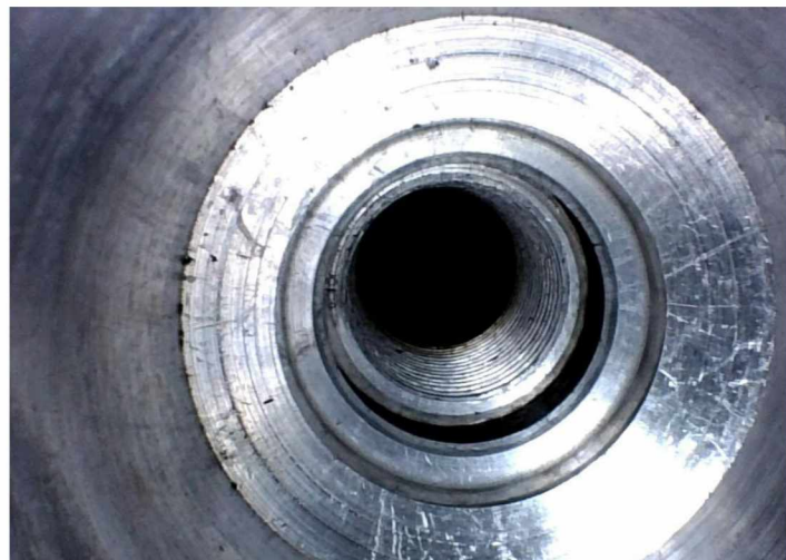
Fotografie výše: Kontrola otvoru zapalovací svíčky
