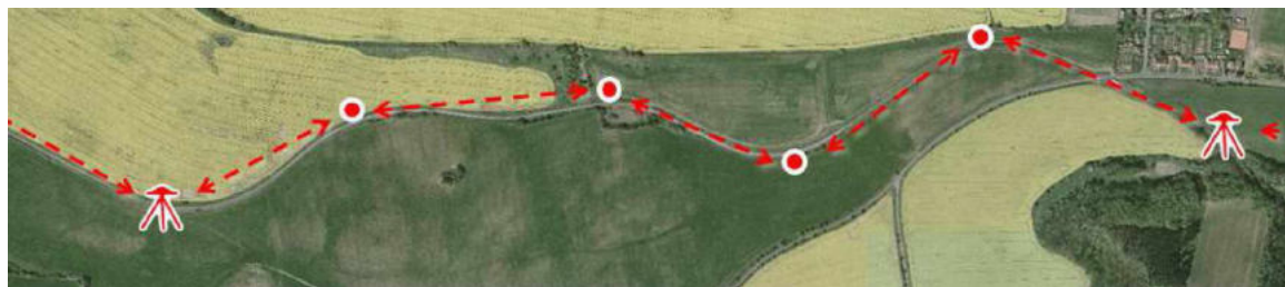
Obrázek 1 Polygonové body mezi dvěma body primární sítě
