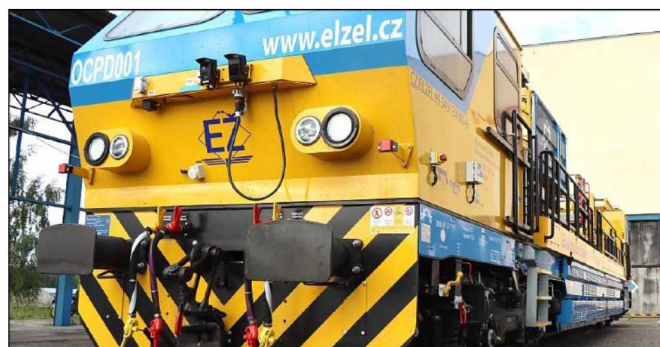
Zástavba ETCS na speciální drážní vozidla OCPD.
