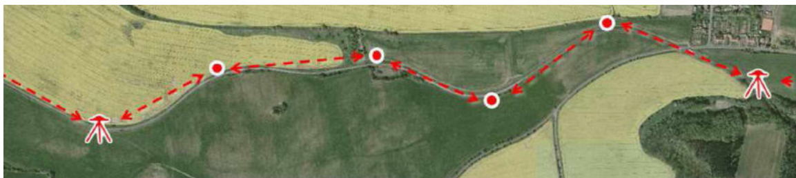
Obrázek 1 Polygonové body mezi dvěma body primární sítě
