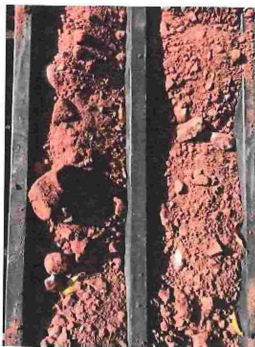
Foto č.3: Násypové horizonty
