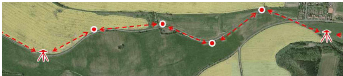
Obrázek 1 Polygonové body mezi dvěma body primární sítě
