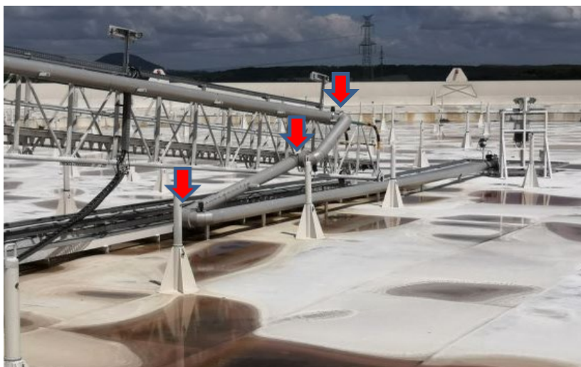
Obr. 4.3 Místa vyznačení otočných kloubů (naplněná nádrž)
