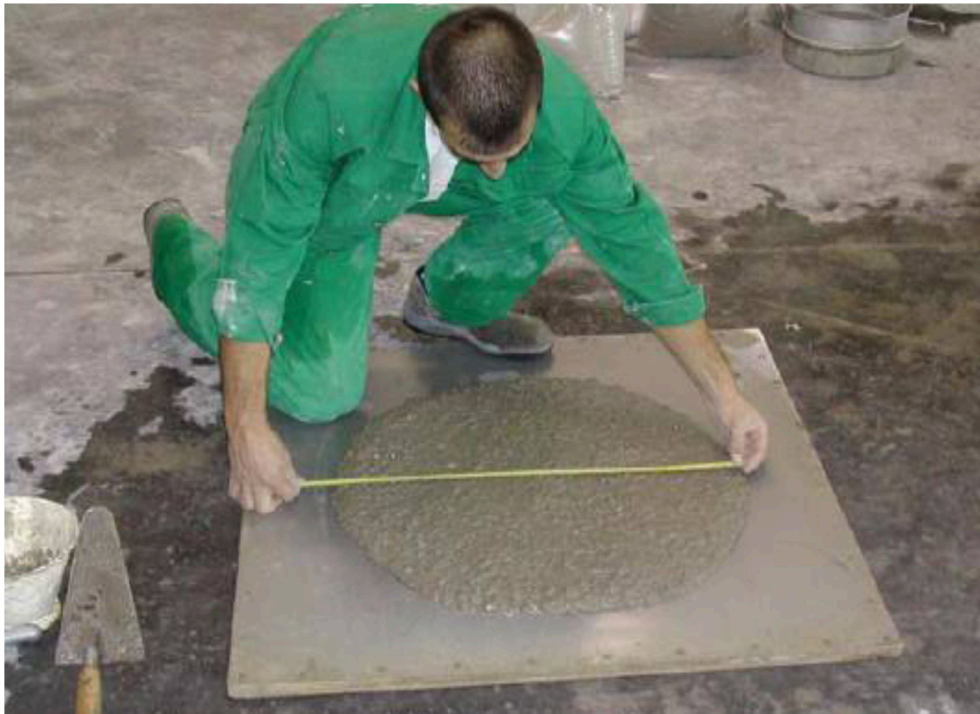
(3) Obr. 3 – Zkouška rozlití SCC - správně navržená směs
