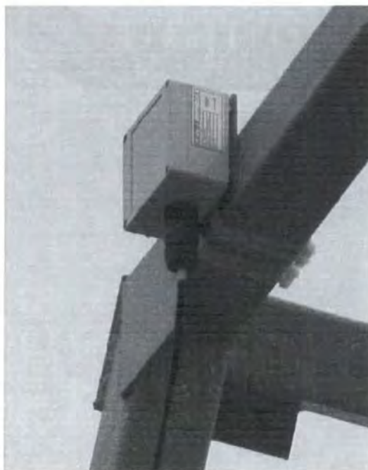
Obr. 14: Přijímač satelitního času UC-STU
