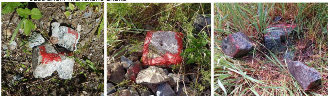
Obrázek 8 Ukázka zničených bodů sekáním trávy
