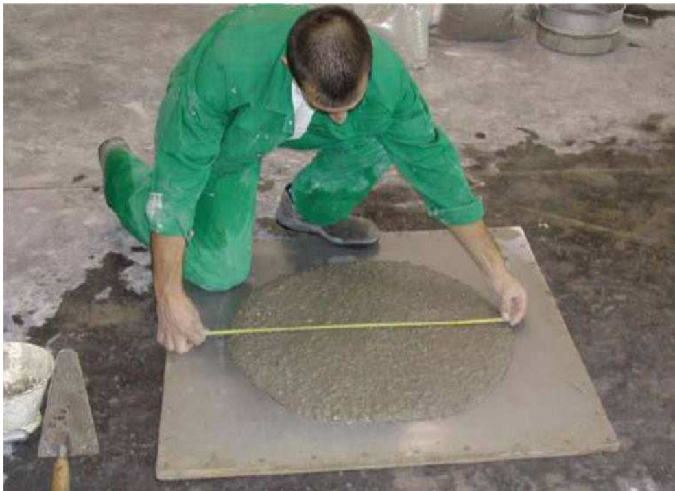
(3) Obr. 3 – Zkouška rozlití SCC - správně navržená směs
