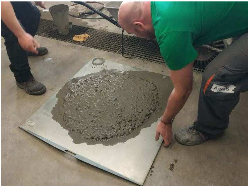
(6) Obr. 6 – Zkouška rozlití SCC - nesprávně navržená směs, vysoká náchylnost k bleedingu (po obvodu vystupuje cementové mléko) a segregaci (shluky hrubých zrn kameniva)
