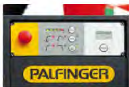
STU01 - Počítadlo motohodin Počítadlo provozních hodin ( digitální nebo přes PALdiag )
