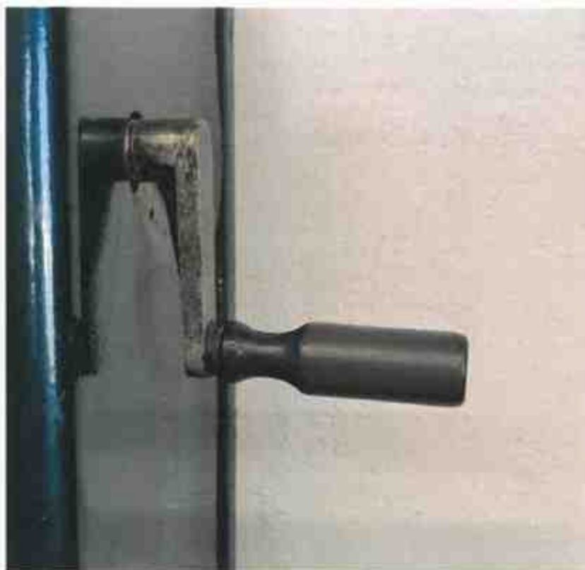
Pohled na kličku induktoru s bakelitovou rukojetí.
