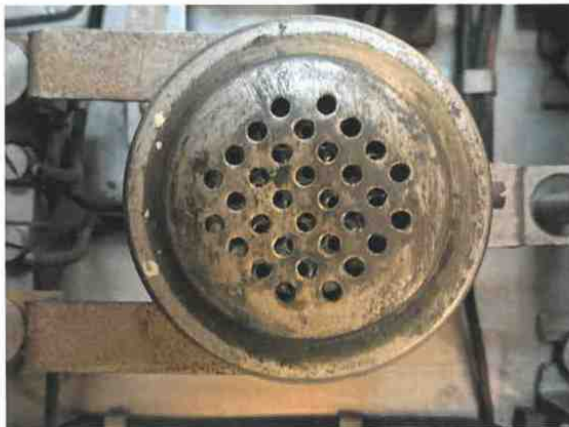
Tvar perforování mluvitka – vloženo do porcelánového prstence.
