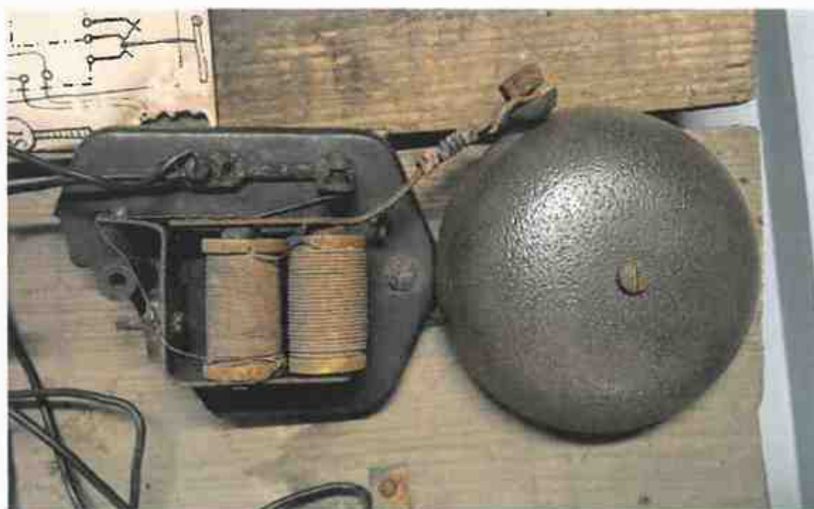
Pohled na těleso zvonku na zmíněném torzu – ozvučný cylindr kvůli hloubkové korozi těžko použitelný /povrchová úprava nikl – lesk/
