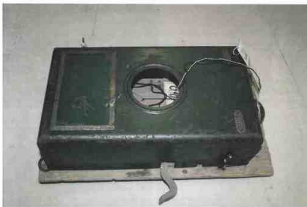
Pohled na kryt mechaniky telefonu – torzo, do otvoru by byla umístěna replika porcelánu.
