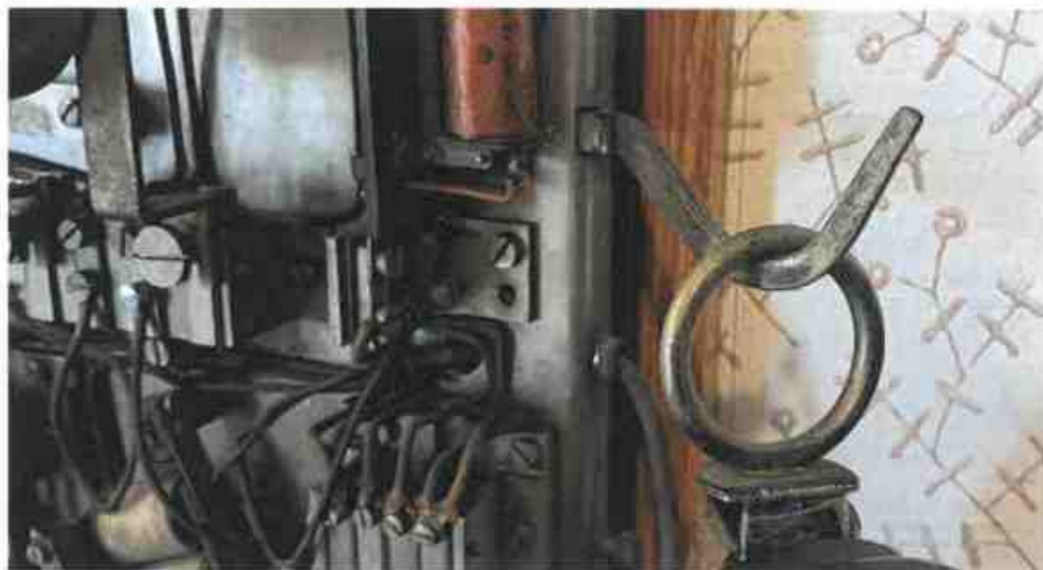
Pohled na jiné zakončení uchycení sluchátka.
