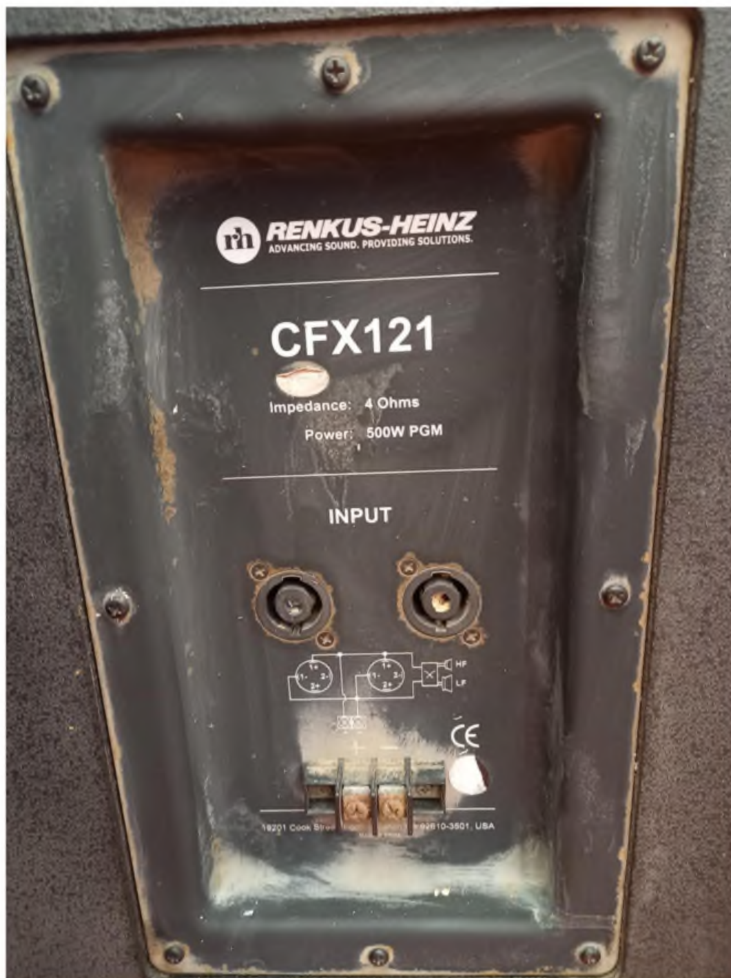
Obr č.8 – Pohled na přípojné konektory exteriérových reprosoustav
