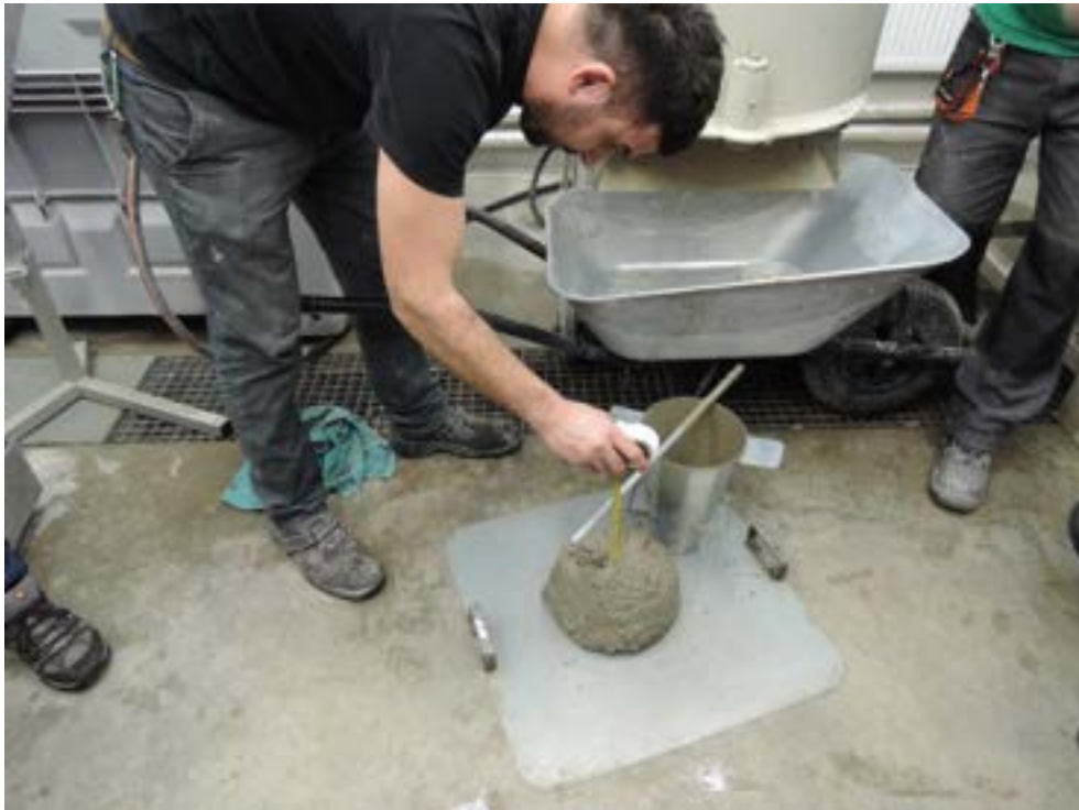
(1) Obr. 1 – Sednutí kužele – správné zhuštění, rovnoměrně sednutý kužel
