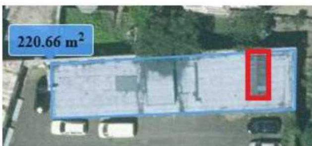
- červené pole 20m2 plechové krytiny
