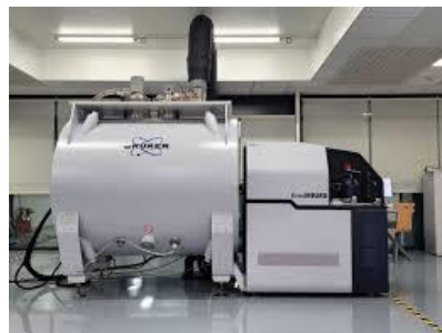
Obr.1: timsMRMS zobrazený s 18T magnetem. Vezměte prosím na vědomí, že součástí nabídky není ŽÁDNÝ magnet, ale zákazník musí dodat vhodný magnet.
