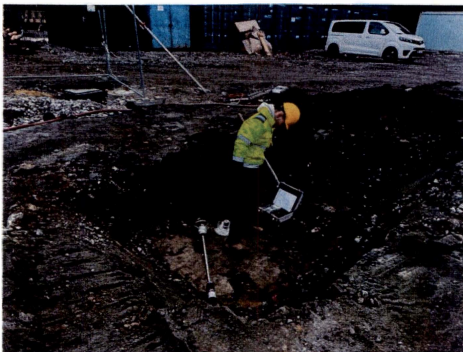
Obrázek 5 Provádění zkoušek LDD na zemínách charakteru F6 CI
