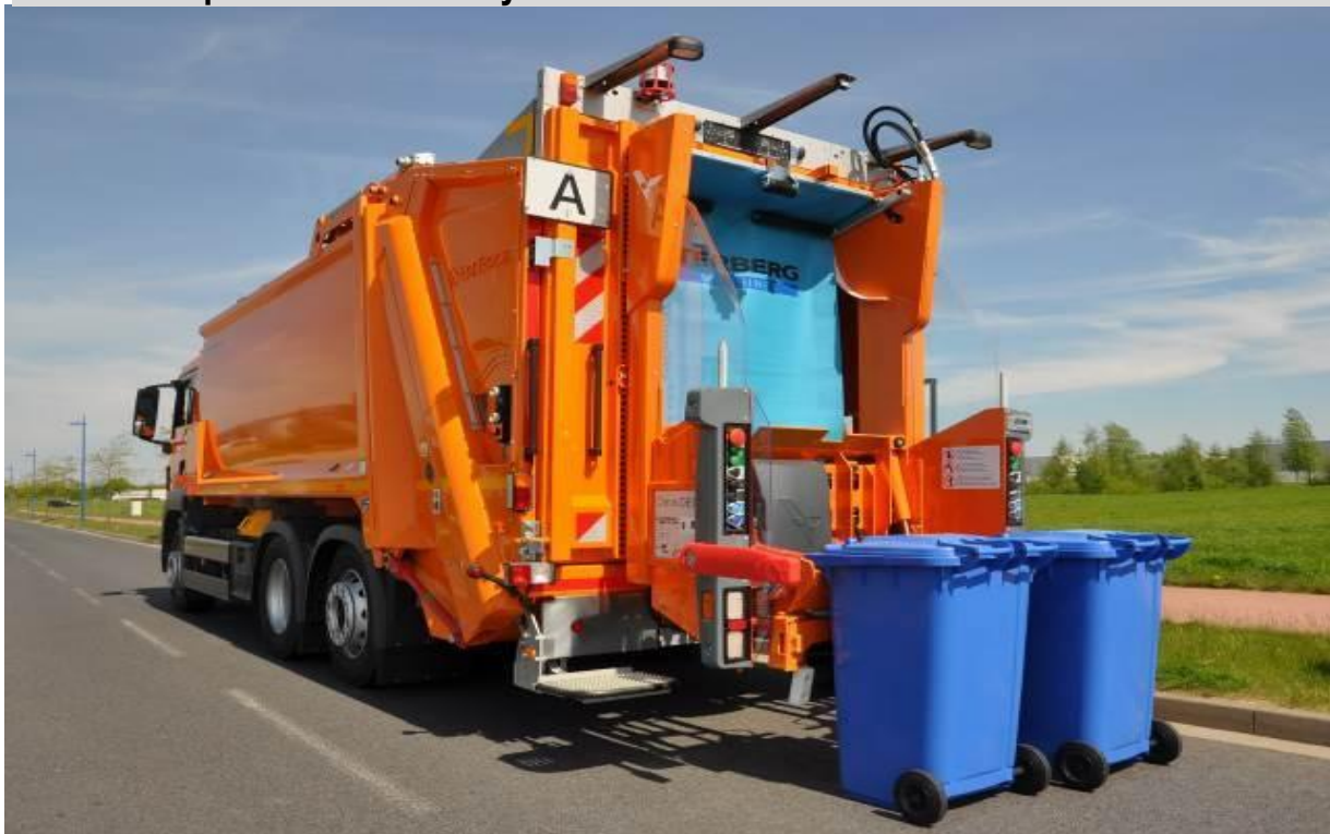
Nástavba s lineárním stlačováním pro svoz veškerého TKO, BIO a separovaného odpadu
