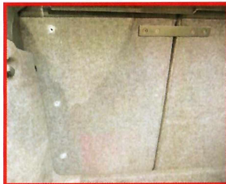
Chybějící přepážka zavazadlového prostoru
