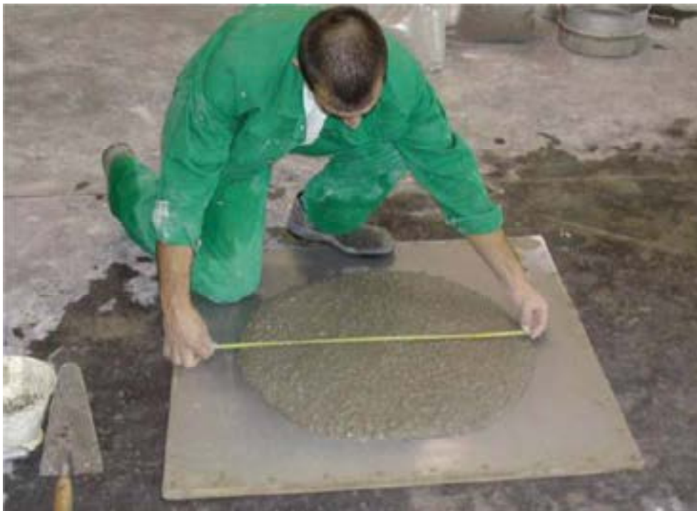
(3) Obr. 3 – Zkouška rozlití SCC - správně navržená směs
