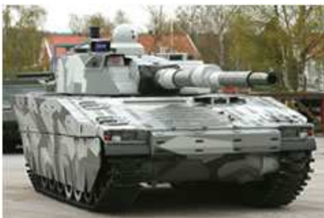
Obr. 4. Lehký tank CV90 120 vybavený systémem aktivní ochrany AAC
