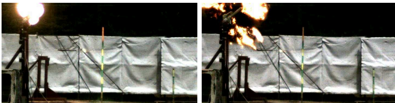
Obr. 3a,b. Jednotlivé fáze interakce protiopatření EFA s bojovou hlavicí PG-7V
