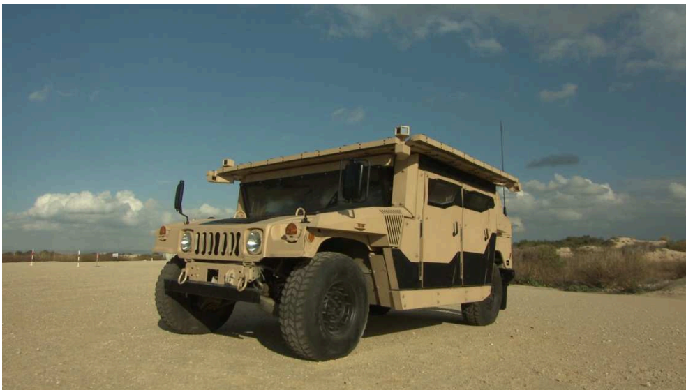
Obr. 8. Vozidlo HMMWV vybavené prototypem systému aktivní ochrany Trophy - LW
