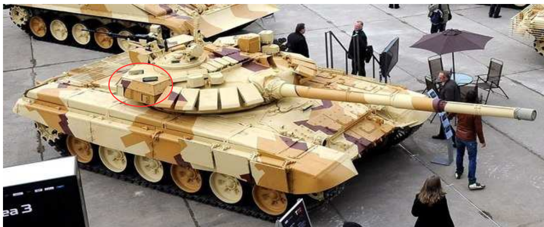
Obr. 5. Tank T-72 s nejnovější verzí aktivní ochrany ARENA-3 (boxy v zadní části věže)
