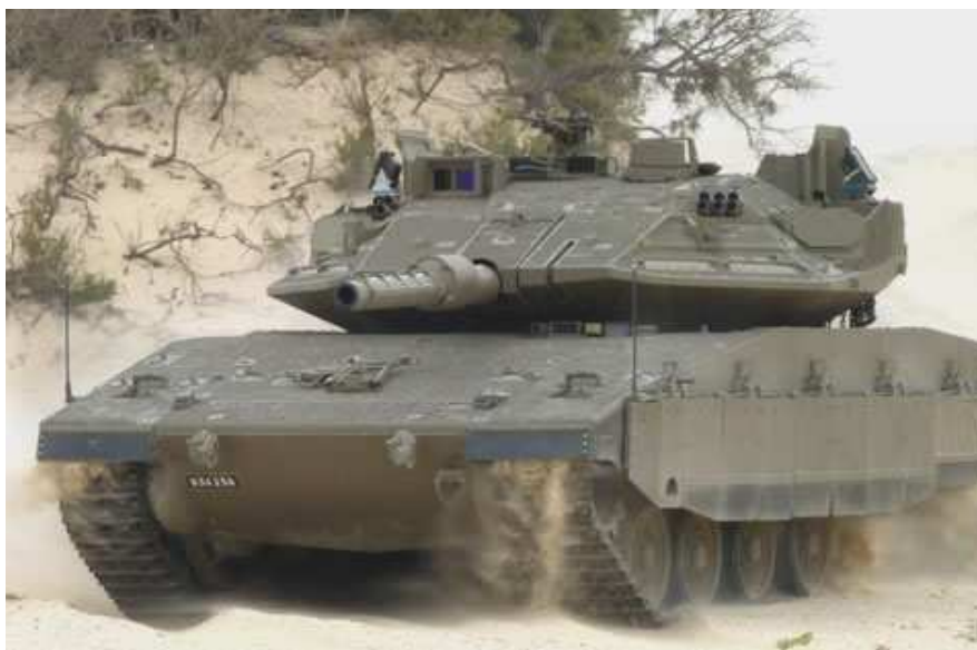
Obr. 6. Tank Merkava Mk4 vybavený systémem aktivní ochrany Trophy
