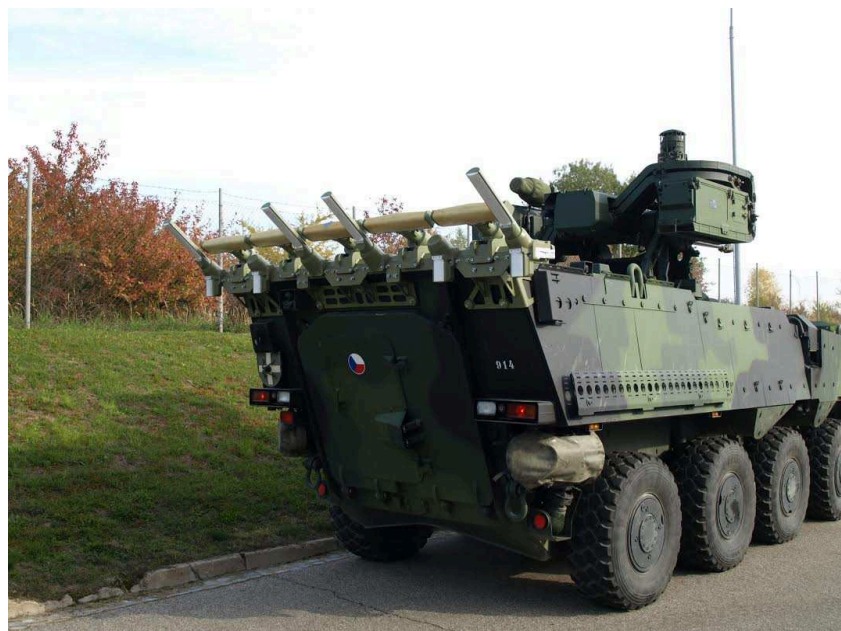
Obr. 2. Prototyp systému AKTIVNÍ OCHRANA II na KBVP Pandur II
