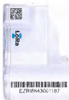
EDC modul pro dálkový odečet sítě LoRaWAN
