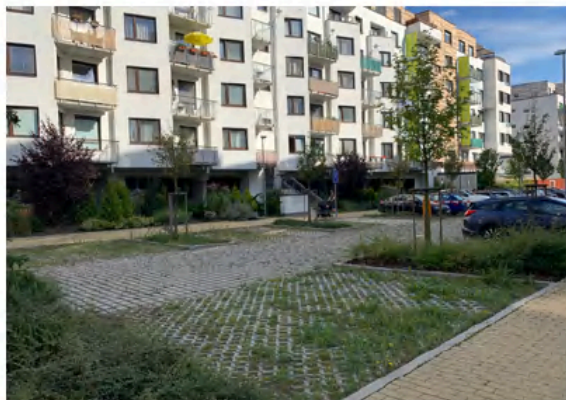
Zatravněvací a zasakovací dlažba
