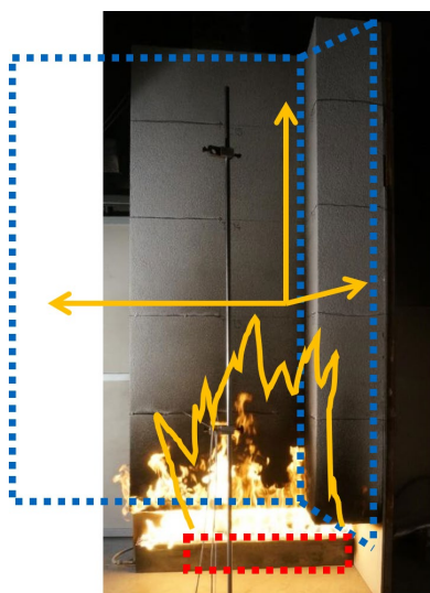
obr. 4: Záměr modifikované středněrozměrové zkoušky šíření požáru po fasádě vycházející z ČSN ISO 13 785-1
