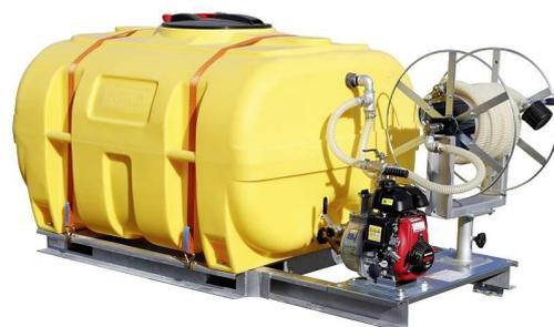
Zavlažovací systém se skládá z ocelového pozinkovaného rámu, polyethylenové nádrže o objemu 1000 litrů, benzínového čerpadla a otočného navijáku na hadici. Celý komplet lze snadno instalovat na korbu nákladního vozu a tím získáte zavlažovací systém nezávislý na externím zdroji energie. Čerpadlo Honda má výkon 130 l/min při tlaku 3,5 bar.
