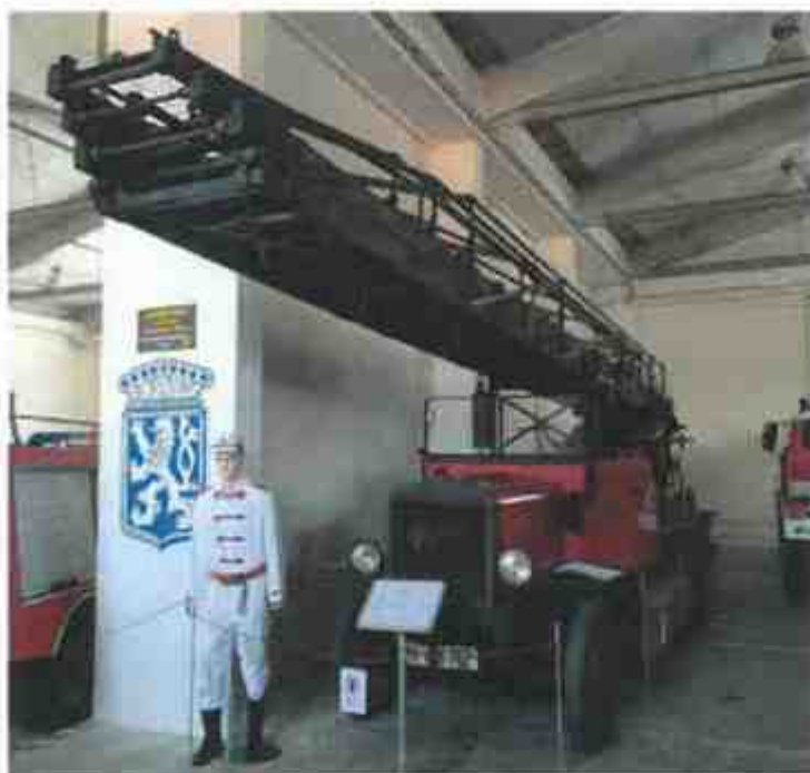
11. Praga N, výrobní číslo 21539, rok výroby 1928, hasičský vůz s výsuvným žebříkem Metz
