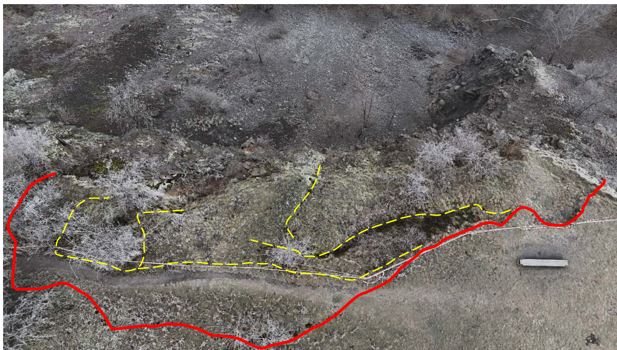
Obrázek 6: horní pohled na odtrhovou zónu nestabilního masivu PP Zámky, červená linie vymezuje úplný rozsah hlavní odtrhové linie, žluté linie jsou výchozy podružných zlomových a odtrhových struktur masivu s významnými poklesy
