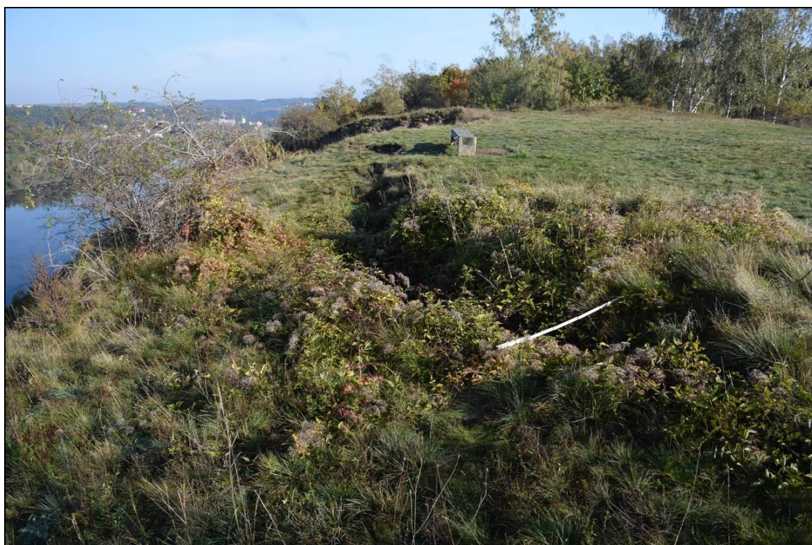
Foto 2 Pohled na odlučnou trhlinu od jihu. Měřítka ilustruje bílý dvoumetr položený kolmo přes trhlinu, rozbalený na délku 1 m.
