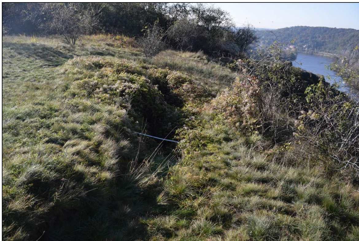
Foto 3 Pohled na odlučnou trhlinu od severu. Měřítko ilustruje bílý dvoumetr položený kolmo přes trhlinu, rozbalený na délku 1 m.
