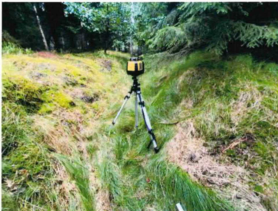
Obrázek 1: Výškové zaměřování přehrázek
