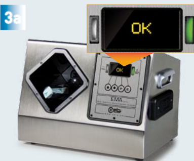
POKUD JE OBSAH IDENTIFIKOVÁN JAKO VYHOVUJÍCÍ, je zobrazena zpráva "OK" a rozsvícena zelená kontrolka. Zároveň zazní krátké dvojité pípnutí
