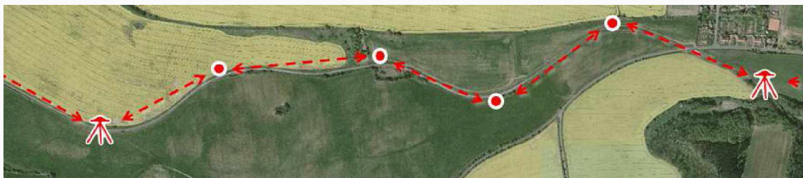
Obrázek 1 Polygonové body mezi dvěma body primární sítě
