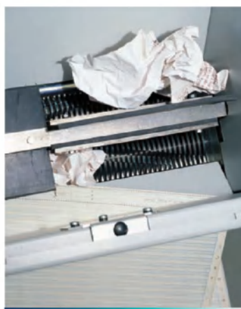
Automatický systém mechanického podávání využívá otočné klapy k podávání materiálu do řezných nožů.
