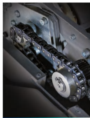
Super silný systém: robustní řetězový převod.
