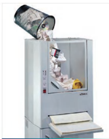
Násypka umožňuje uživatelům jednoduše vyprázdnit koš na papír přímo do stroje.
