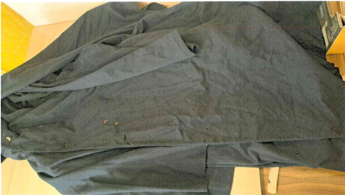
Detail poškození - rozesté drobné trhlinky na levé části PD
