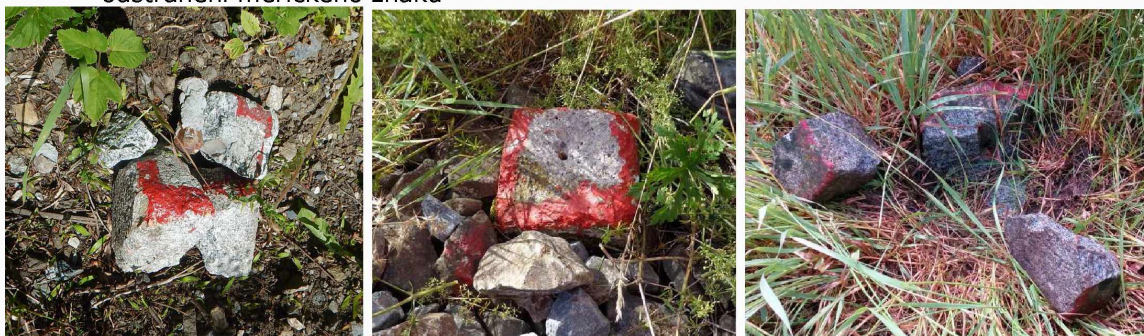
Obrázek 8 Ukázka zničených bodů sekáním trávy
