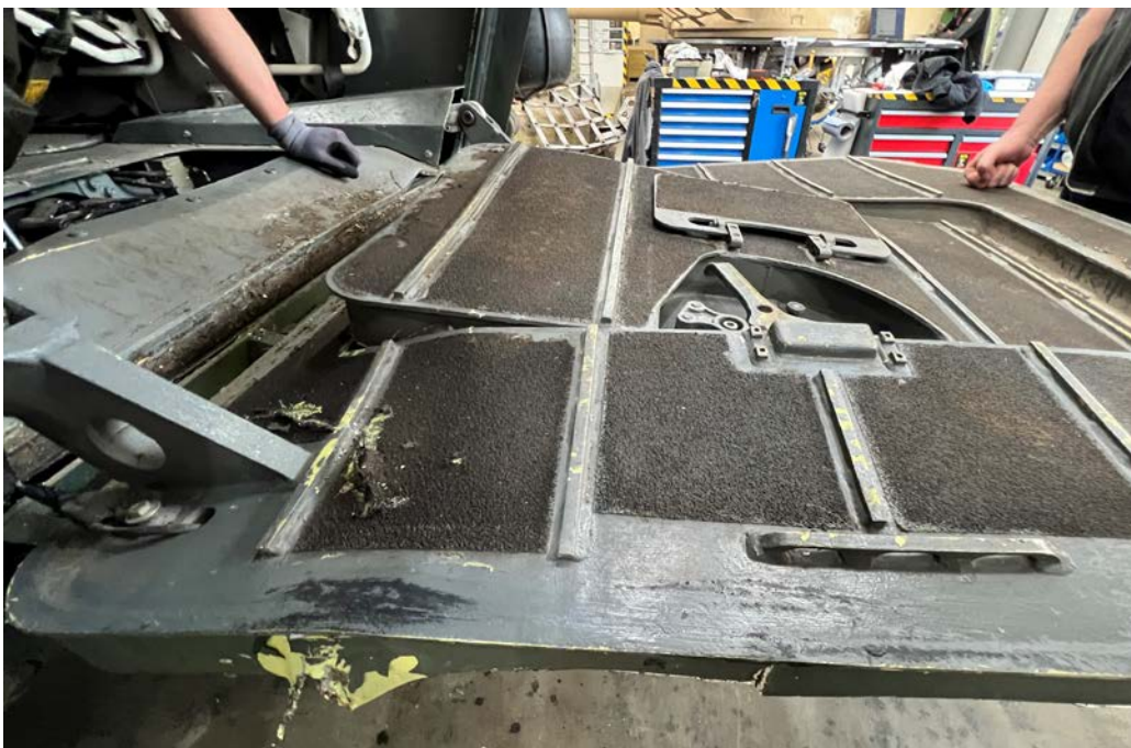
Zdeformovaná rampa vozidla
