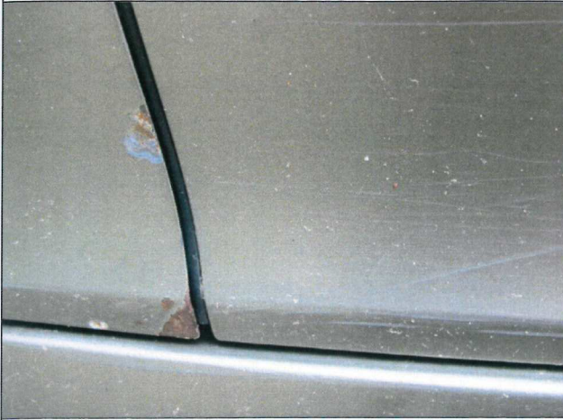
Koroze LP dveří
