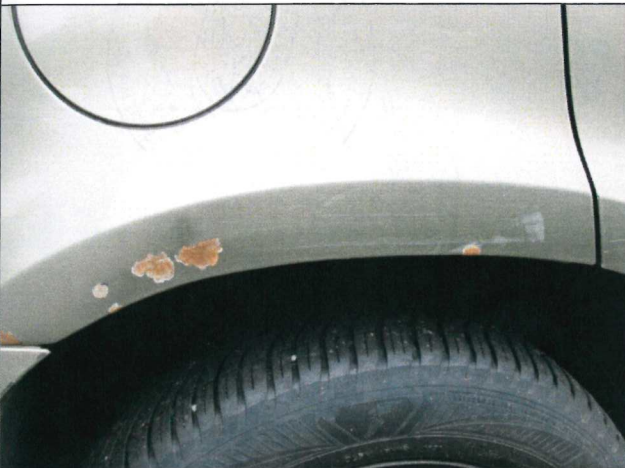
Poškození PZ blatníku
