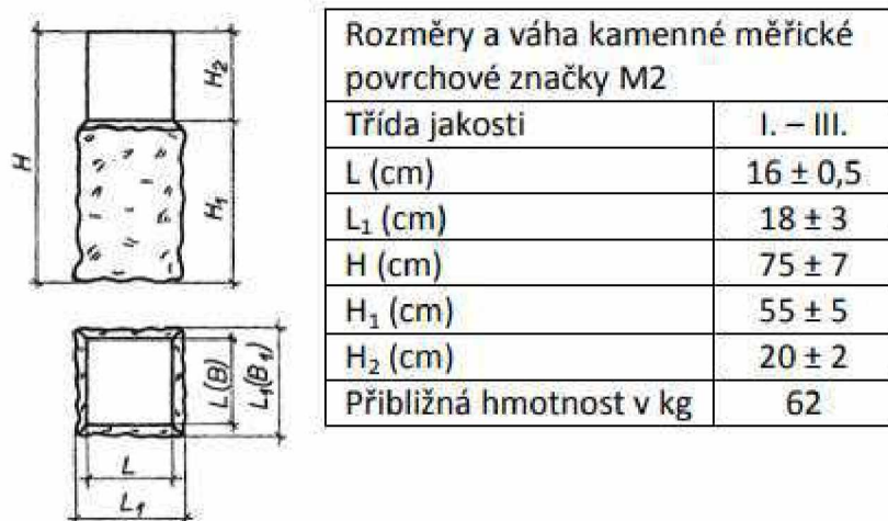
Obrázek 5 Rozměry povrchové kamenné značky M2
