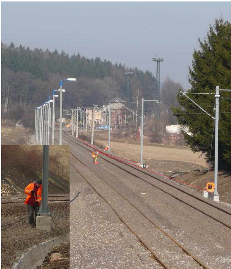
Obrázek 23 Určení souřadnic volně postaveného stanoviska ze zajišťovacích značek na podpěrách TV
