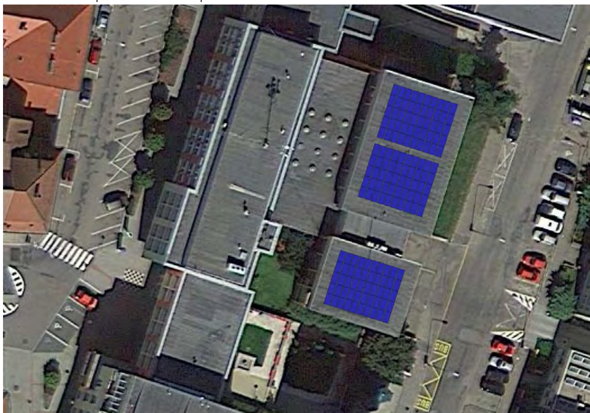
Obr. č. 8.1.1: Předpokládané rozvržení panelů
