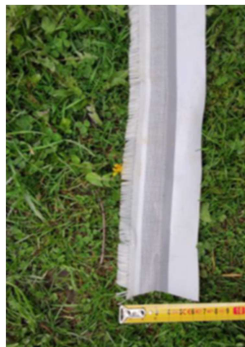
Alternativní vhodný trvanlivý materiál pro zvýraznění oplocenek – páska s výstužnou tkaninou (ořezy z výroby auto plachet) + vhodné rozměry pro pásky
