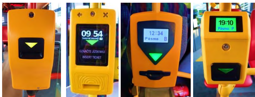
Obrázek 12: Příklady provedení označovače jízdenek (NJ 24C, Camel-Combi, SU 52, ETM 4.0)
