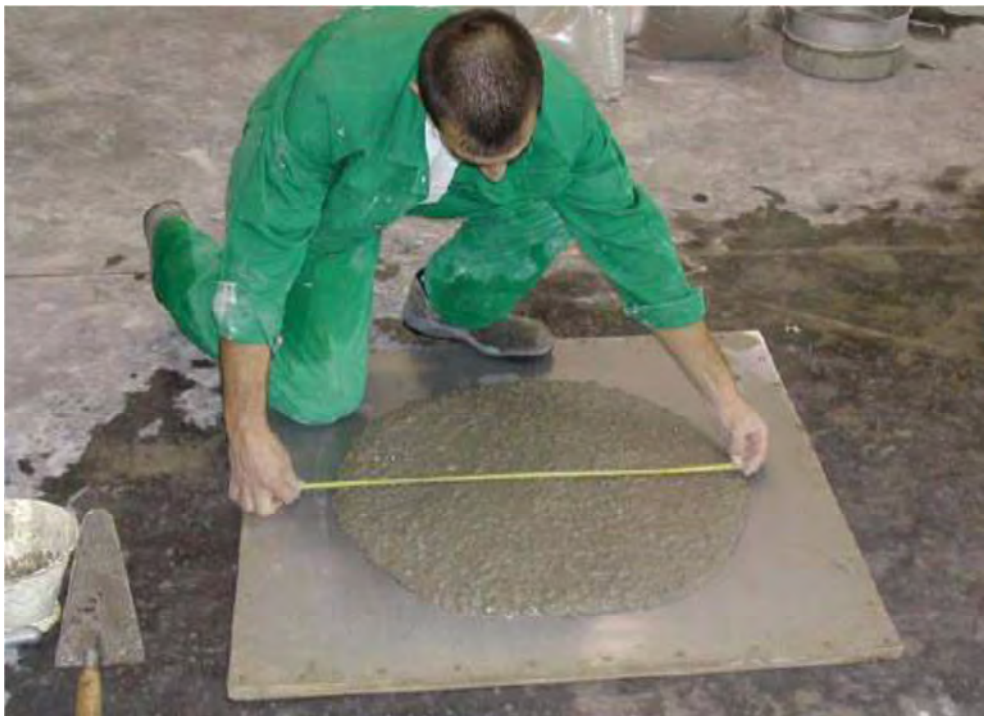
(3) Obr. 3 – Zkouška rozlití SCC - správně navržená směs
