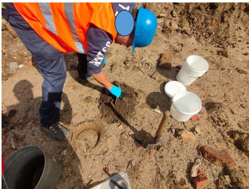
Obrázek 3: Kvartace odebíraného vzorku z kopané sondy KS 102; Provádění odběru druhé poloviny děleného vzorku (ekologická laboratoř Peal s.r.o.) do plastových kbelíků
