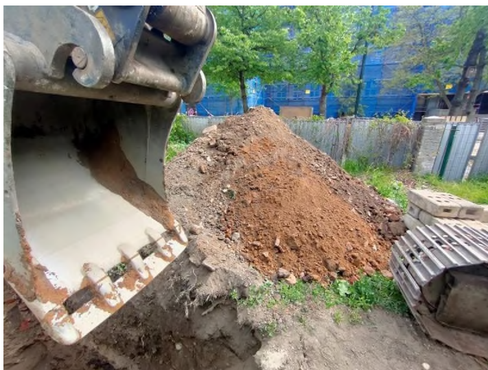
Obrázek 2: Výkopek kopané sondy KS1; patrný rozdíl mezi materiálem vzorku SM1 (navážka) a SM2 (písčitý sediment fluválního charakteru)
