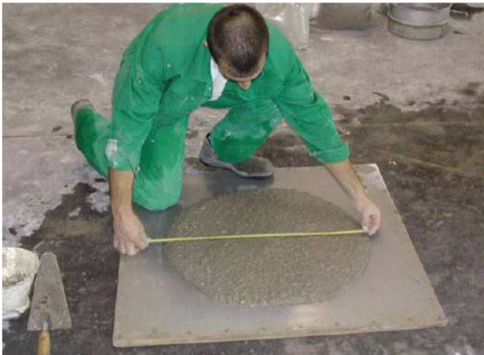
(3) Obr. 3 – Zkouška rozlití SCC - správně navržená směs
