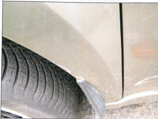
Koroze LP blatníku
