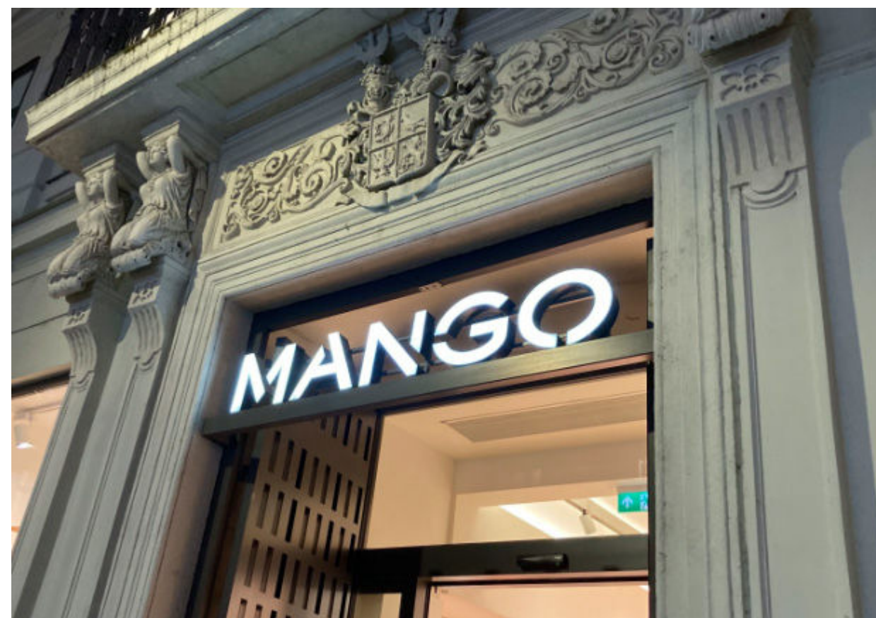
Hliníkový skelet s plexisklem prosvícený zevnitř
